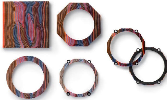
MTG-B2000XMG-1AER Stappen in het fabricageproces van de meerkleurige carbon bezel
