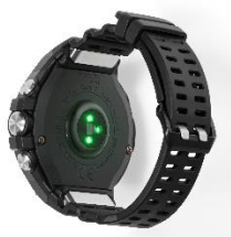
Sensor ótico Novo mostrador frequência cardíaca (esquerda: Padrão / direito: Atividade)
